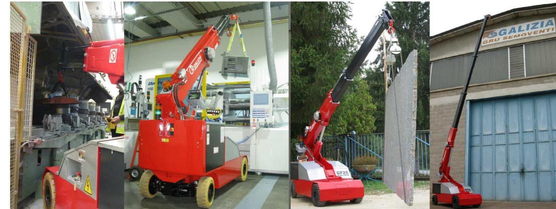
trazione anteriore bimotore con contro rotazione e sterzata totale
